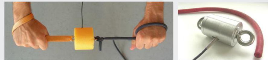
Einsatz eines Kraftsensors für die Genauigkeitsanalyse
